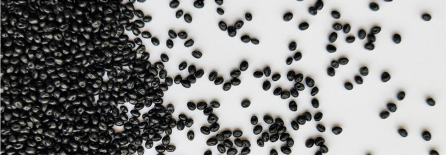
Polyethylen mit hoher Dichte (PE-HD) ist ein vielseitig einsetzbarer Kunststoff. Dieses Material ist eines der am stärksten verbreiteten Werkstoffe im Bereich des industriellen und kommunalen Abwassers. Dank seiner organischen Zusammensetzung von ausschließlich Kohlen- und Wasserstoff, durch die keine giftigen Inhaltsstoffe ausdiffundieren können, steht PE für Nachhaltigkeit und eine hervorragende Umweltbilanz.
