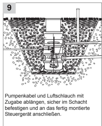
Die Schächte werden vom Werks-LKW oder Spediteur zur Baustelle geliefert und können mit leichtem Gerät in die Baugrube versetzt werden. Die Bauform der dargestellten Pumpstation ist willkürlich gewählt und entspricht nicht unserem Lieferstandard.
