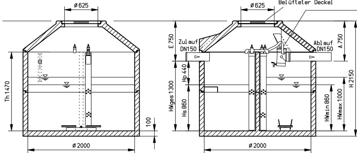
Der Probenahmetopf muß mit einer Kette am Konus befestigt werden!
